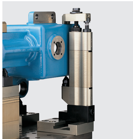
Das Werkstück sitzt fest, mit der einge- pressten Auflage- spitze.
