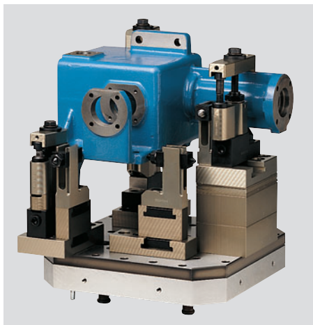
Spannen eines kompletten Guss- teiles.
